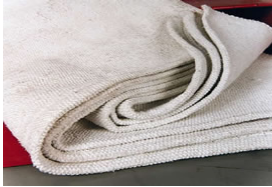
Asbestos fire blanket
